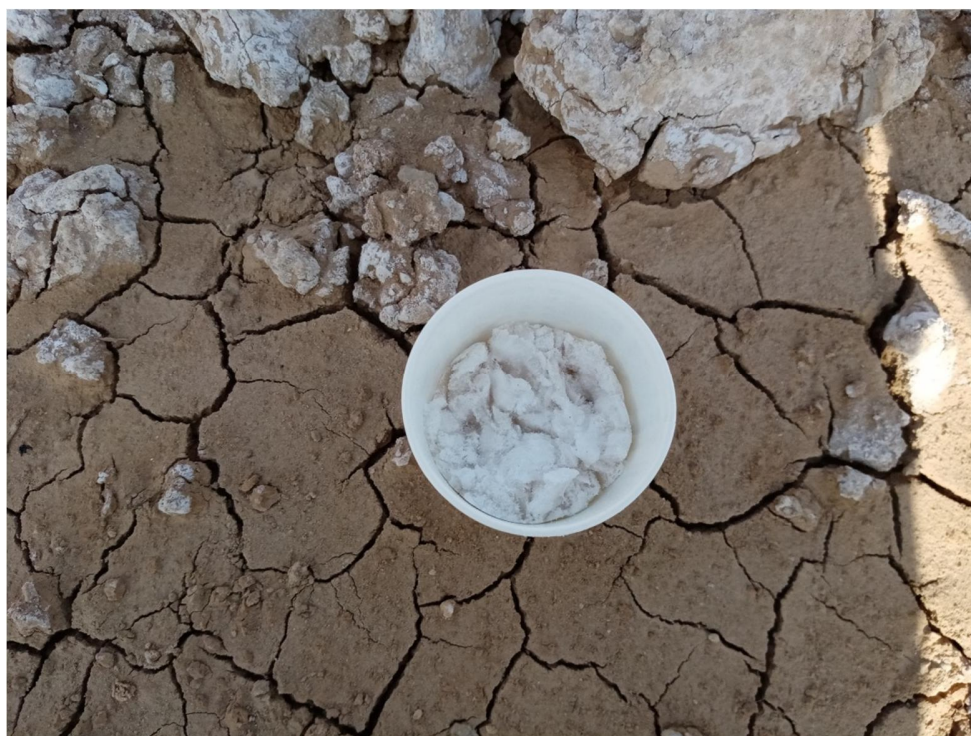
توضیح تصویر: برداشت مقداری سولفات سدیم هیدراته شده از دیواره یک ترانشه در ضلع شمالی شهرک صنعتی ایبک آباد
